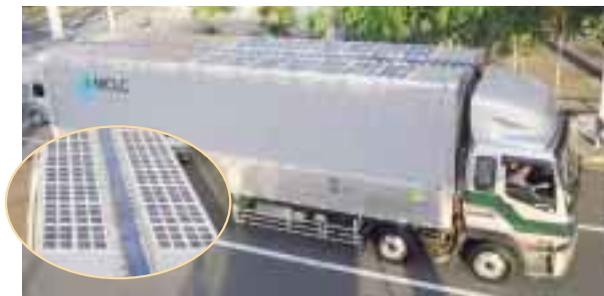
三菱化学が、太陽光発電によるトラック冷房システムを開発し、燃料消費を抑え、排気ガス量を削減
