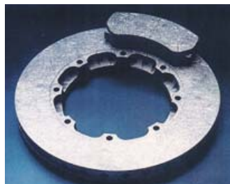
▲ 炭素繊維・樹脂の複合材とケイ素を使用した軽量・高性能の自動車用ブレーキディスク (三菱化学産資(株))
